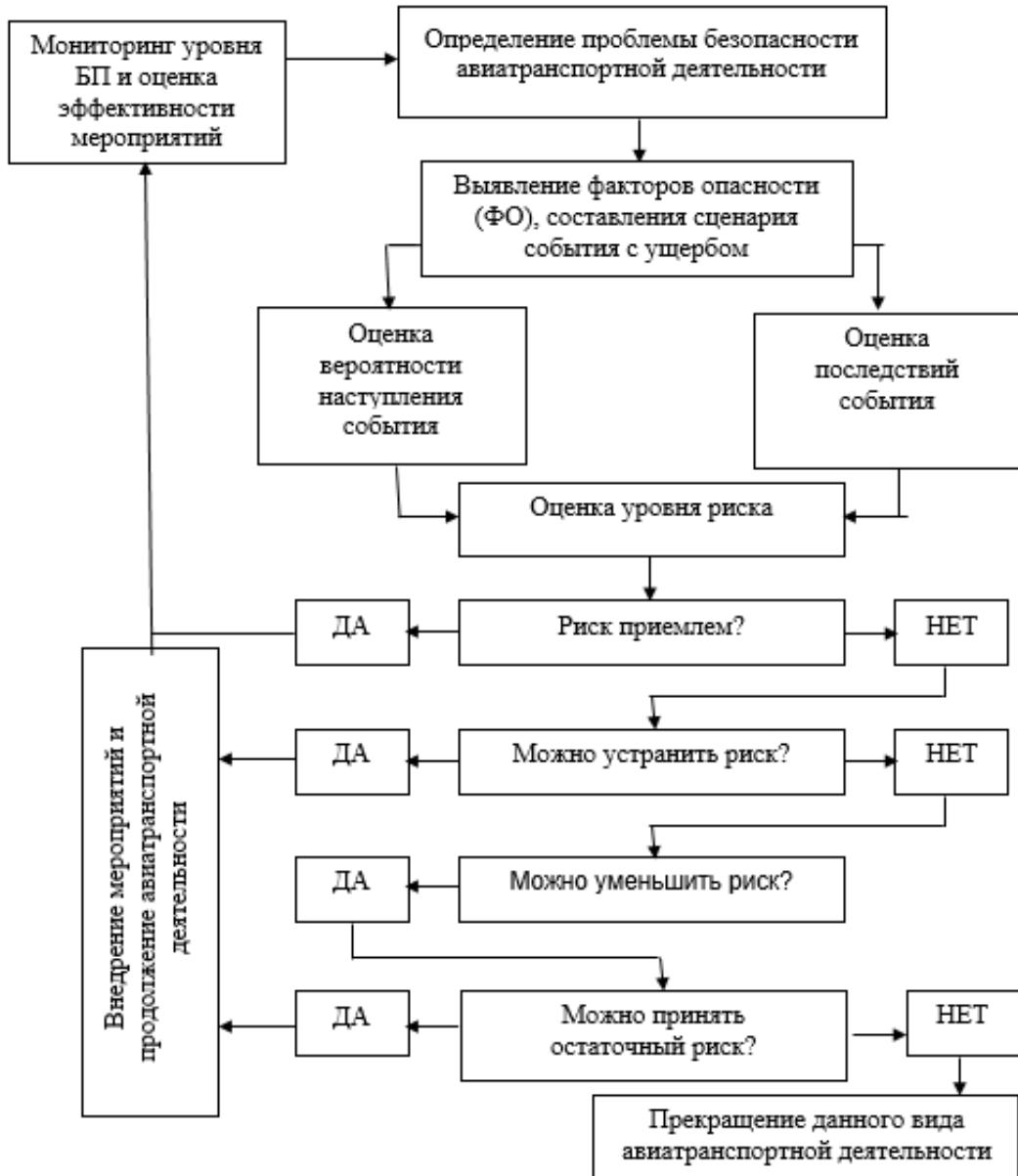
Рисунок 4. Схема управления риском для безопасности полетов
